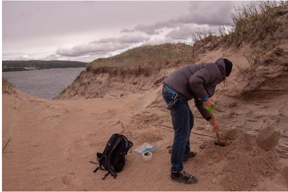
Figure 1. Échantillonnage de dépôts sableux à Whapmagoostui-Kuujuarapik pour la mesure des propriétés thermiques en laboratoire.
