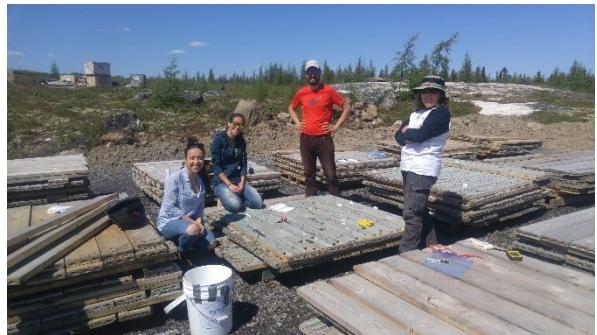
Figure 2. Description et échantillonnage de carottes de forage appartenant à Midland Exploration au camp de Kuujuaq.
